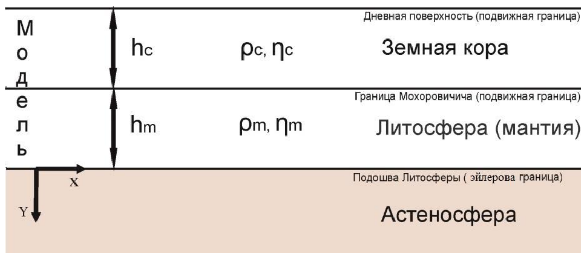
Рис. 1. Схема модели I (задача о влиянии астеносферной конвекции).
